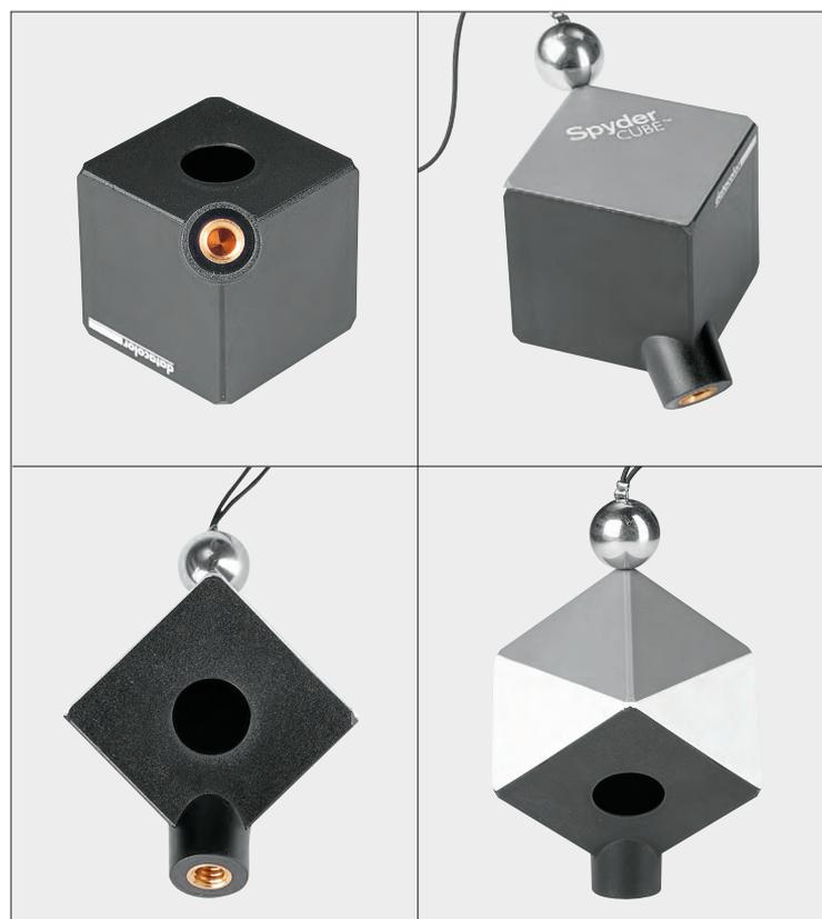
У кубика две бело-серые грани, одна серая, две черные и одна черная с нишей. К одной из вершин прикреплен металлический шарик с полированной отражающей поверхностью для контроля на снимке яркости бликов. По белому полю кубика настраиваются цвета, в которых еще видны детали, по черному — тени с деталями. Если в нишу на черной грани не попадает свет, она будет мишенью
